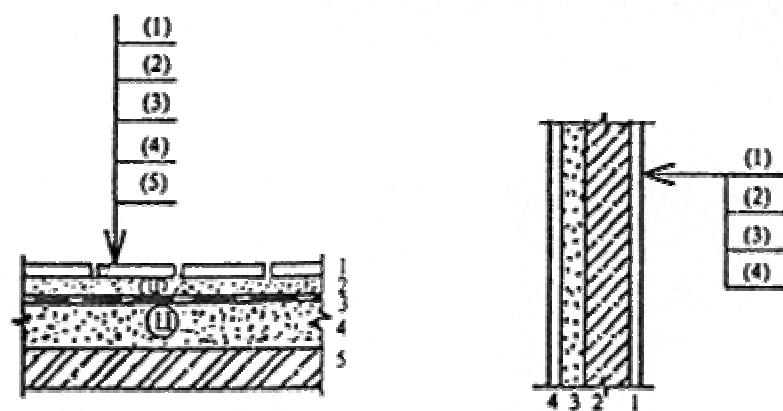
Примечание. Цифрами условно обозначена последовательность расположения слоев конструкций и надписей на полках линий-выносок.
