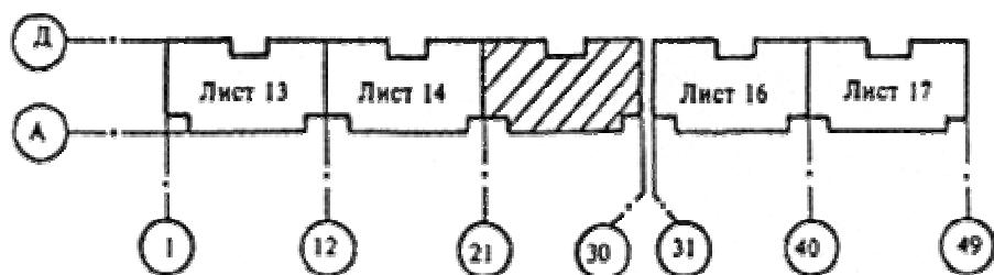
Примечание. Если чертежи участков изображения помещены в разных основных комплектах рабочих чертежей, то над номером листа указывают обозначение соответствующего основного комплекта (согласно 4.2.2).
